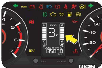
Nelle salite o nelle curve, a causa del movimento del carburante nel serbatoio, il livello di carburante potrebbe fluttuare o la spia di livello carburante basso potrebbe accendersi prima del previsto. Controllare sempre il livello del carburante dopo aver parcheggiato la vettura su una superficie piana.
