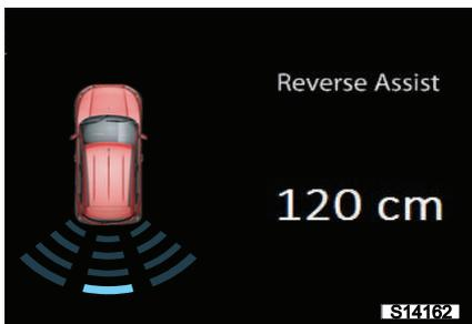
7. La distanza dell'RPAS visualizzata sarà la distanza minore rilevata dai sensori sinistro, centrale e destro, mentre 120 cm è il range di rilevamento massimo.
