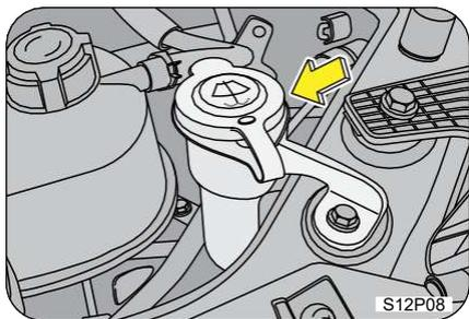
Rabboccare il serbatoio del liquido lavavetri come e quando necessario. Il serbatoio del liquido lavavetri si trova a destra del vano motore, dietro al faro. Il serbatoio contiene il liquido lavavetri per il parabrezza e il lunotto (se presente).
