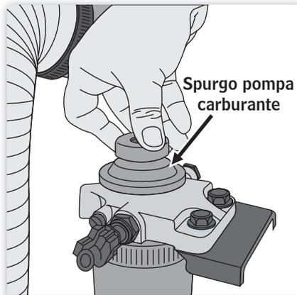
**Caso 2:** Riuscite a sentire il normale rumore del motorino di avviamento, oppure sembra che il motorino di avviamento giri più velocemente del normale, ma il motore non si avvia.
