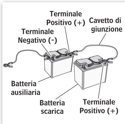
Se la batteria della vettura si è scaricata, potrete essere in grado di avviare il motore utilizzando una batteria ausiliaria. Nonostante questa sembri una procedura molto semplice, è necessario utilizzare numerose precauzioni durante l'esecuzione della stessa.
