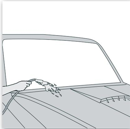
Durante il lavaggio, verificate che non vi siano piccole rotture e graffi che potrebbero causare corrosione. Riparatele utilizzando la vernice per ritocchi prescritta.
